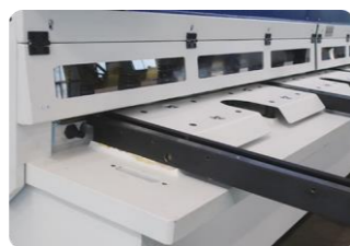
Боковой упор с откидываемым ограничителем 1000мм
